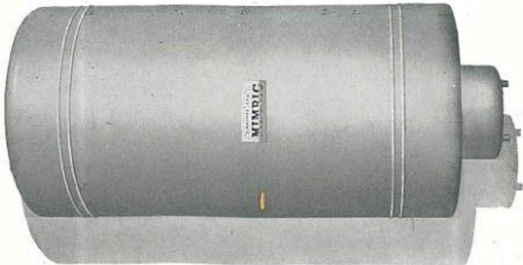
CHAUFFE-EAU 200 LITRES TOLE ACIER GALVANISÉE - SOUDURES AUTO- GÈNE ET ÉLECTRIQUE - CALORIFUGEAGE LIÈGE - TOUT COURANT 2000 WATTS - POIDS 105 KGS. Diamètre 630 mm - Hauteur 1350 mm y compris la calotte d'équipement. Ecartement des pattes de fixation : largeur 340 mm - Hauteur 800 mm
